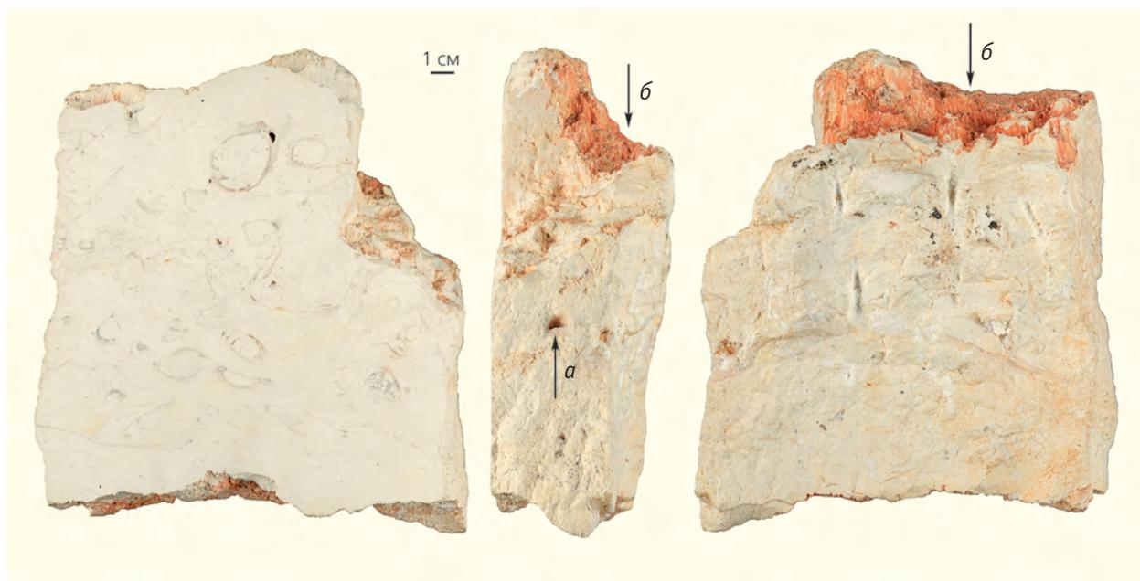
Рис.4. Фотография образца с трех сторон. Стрелками показаны: раковина — «геологический уровень» (а) и поверхность зеркала скольжения (б).
